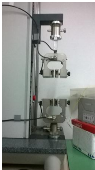
Figure 2.25 : Mesure de la résistance mécanique des membranes (module de Young).
