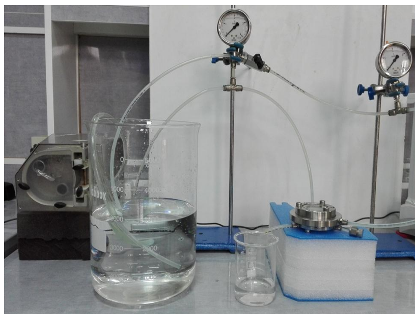
Figure 3.7 : Montage de filtration tangentielle au laboratoire EVER à l'UDES.
