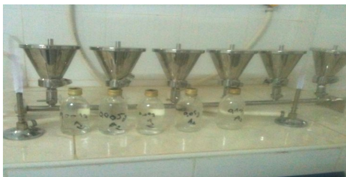
Figure II.7 : Rampe à eau
