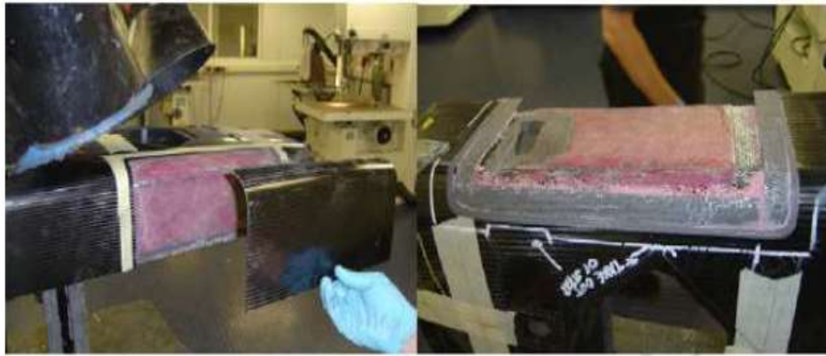
Figure III.12. Réparation d'un châssis du véhicule F1 par patchs composites [128]
