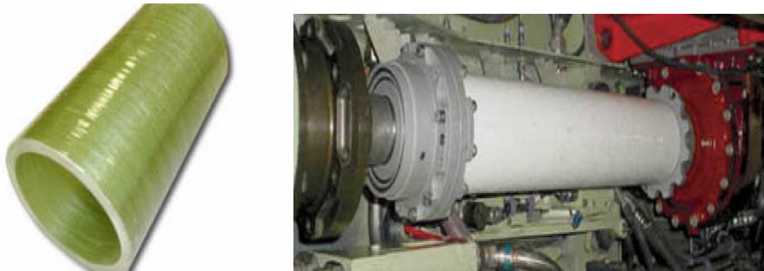
a) Tube en verre- époxyde b) Arbre de transmission en carbone- époxyde (domaine maritime) Figure I-6 : arbre en Matériaux composite. [44-45]
