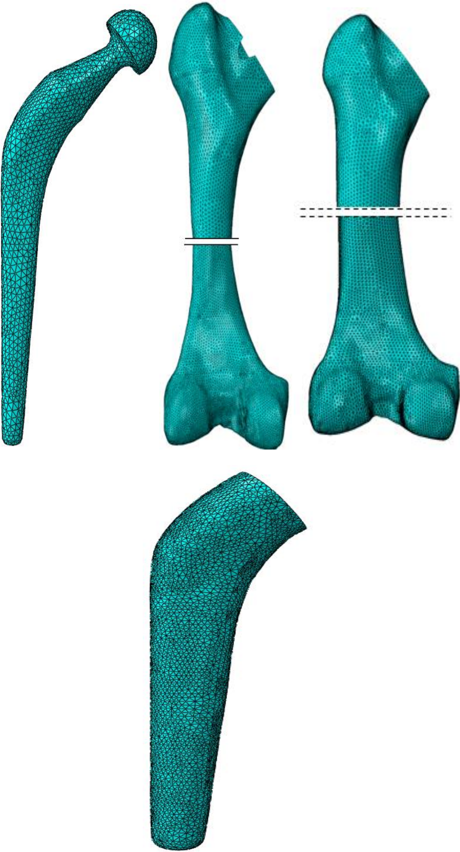
Figure III.3 : Maillage de la prothèse analysée.
