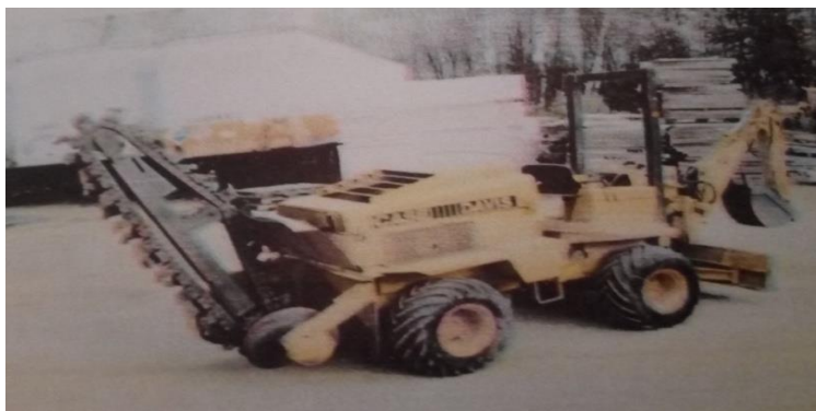
Figure 14 : machine Davis-trancher pour l'ouverture rapide de tranches étroites (Web Master,04) .
