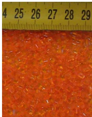
Figure IV.1 : Echantillon des granules de polycarbonate (PC)
