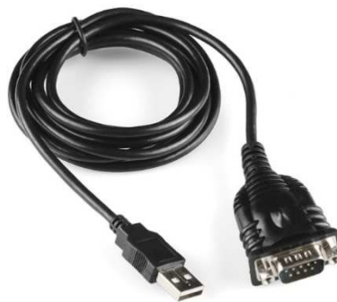
Figure II.16 : Port série RS-232/USB.
