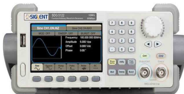
Figure III.10 : Générateur de fonction Siglent SDG 1025.
