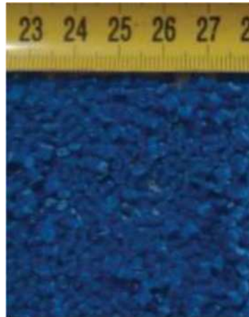
Figure III.4 : Échantillon des granules de polyamide (PA) utilisés.
