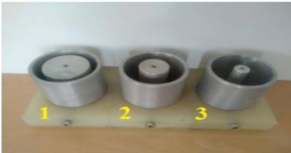
Fig.4.2. Photographie des trois chambres cylindriques utilisées (1: D = 1 \text{ cm} ; 2: D = 2 \text{ cm} et 3: D = 3 \text{ cm} )
