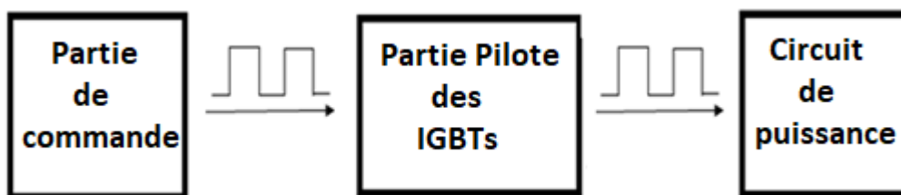
Fig.5.2. Différentes parties du Générateur de Marx à tension négative réalisé
