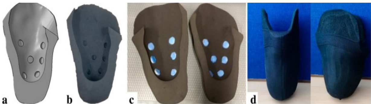
Fig 2.3 Transducteurs intégrés dans un manchon prothétique personnalisé [72].
