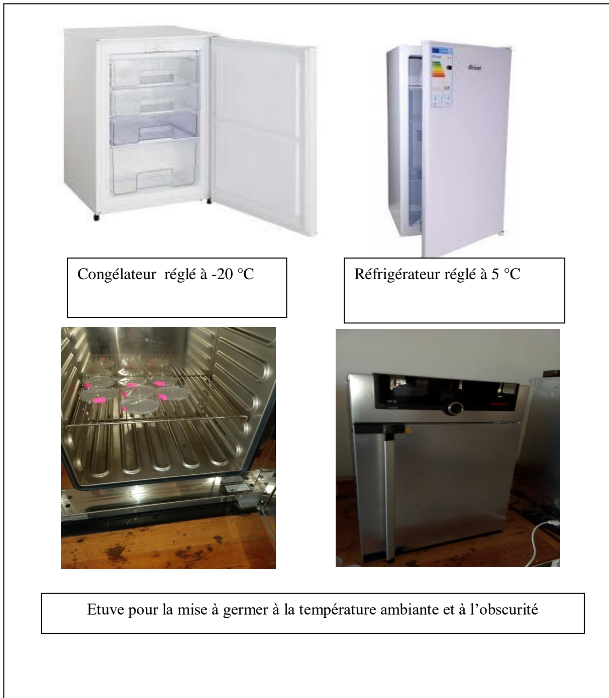
Figure 11: Appareils utilisés dans l'étude expérimentale, congélateur et réfrigérateur pour la conservation et l'étuve pour la germination
