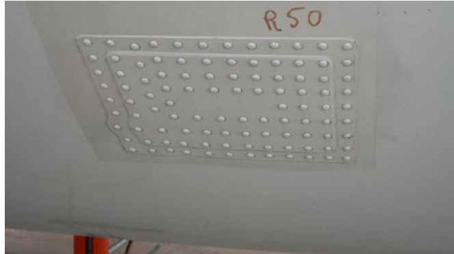
Figure II.13: Réparation par patch riveté sur fuselage de Boeing [48].
