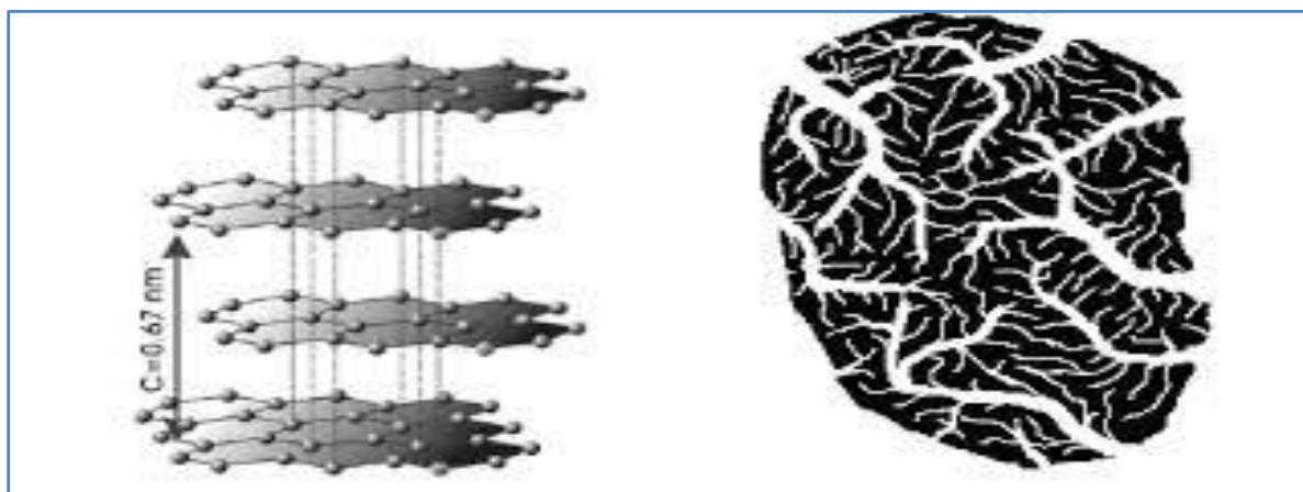
FigureI.2:Structure chimique et poreuse du charbon actif[Zohra(2018)]
