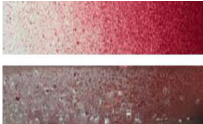
Figure I.10. En haut : texture en fibre de verre avec des éléments de silicium à perméabilité graduée, En bas : essai de l'étanchéité à l'eau, ILEK (Said 2015).
