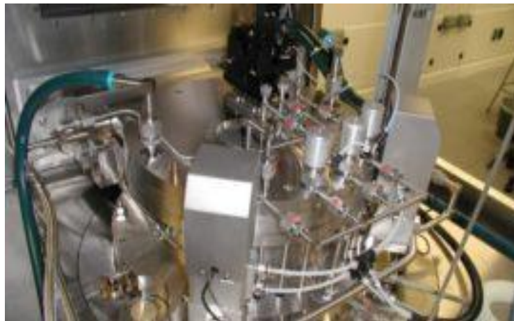
Figure 2.22 : Schéma synoptique d'un bâti de MOCVD et une photo du bâti [26, 27].
