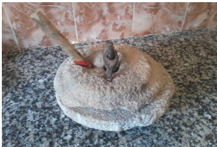
Figure 27 : Illustrant la meule utilisée dans la mouture d'essai
