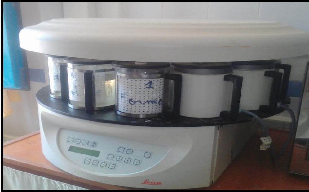
Figure 33. Appareil d'inclusion de paraffine (modèle LEICA EG1160) ©.
