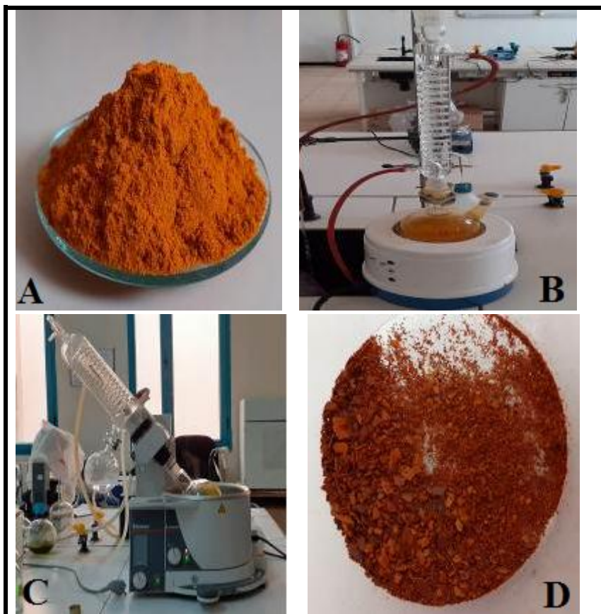
Figure 20. Procédures de préparation de l'EAC. A : broyat des rhizomes sec de C. longa L. ; B : montage d'un système à reflux (décoction); C : concentration à sec de l'extrait à l'aide d'un évaporateur rotatif (modèle Heidolph laborota 4000) ; D : aspect du résidu d'extraction après évaporation rotative.
