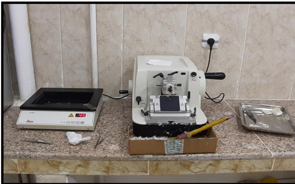
Figure 35. Technique de découpage au microtome (LEICA RM 2235) ©.
