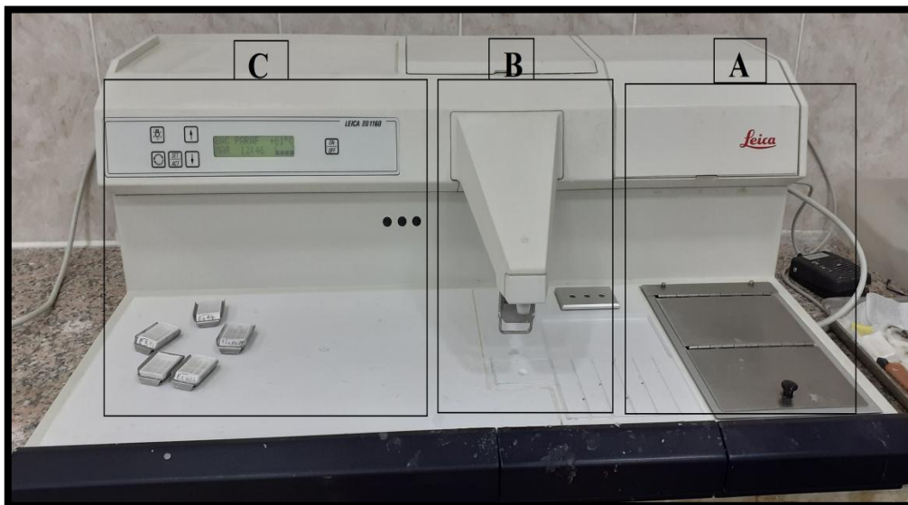
Figure 34. L'appareil d'enrobage, avec deux compartiments chauds (A, B), et un compartiment froid (c) (LEICA EG 1160) ©.
