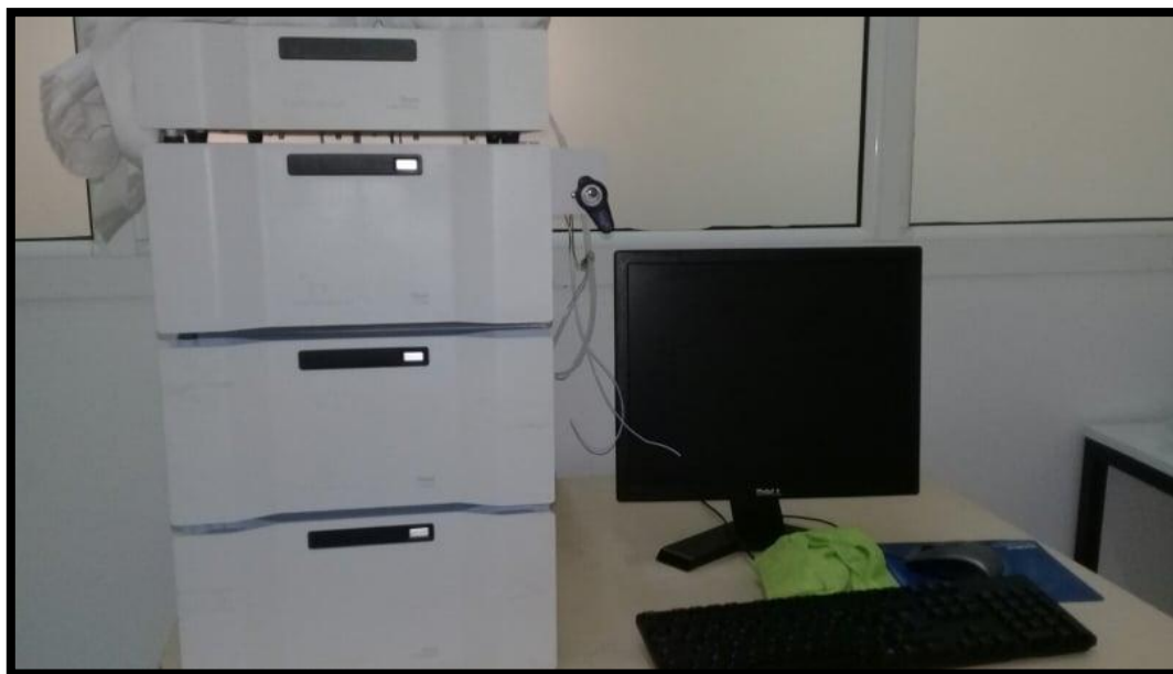
Figure 24. Système HPLC-UV (Agilent Series 1100) utilisé pour l'identification des composants phénoliques de l'EAC.
