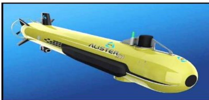
Figure 3: « Série Alister », développé par ECA robotique (France) et destiné à l'étude des fonds marins.
