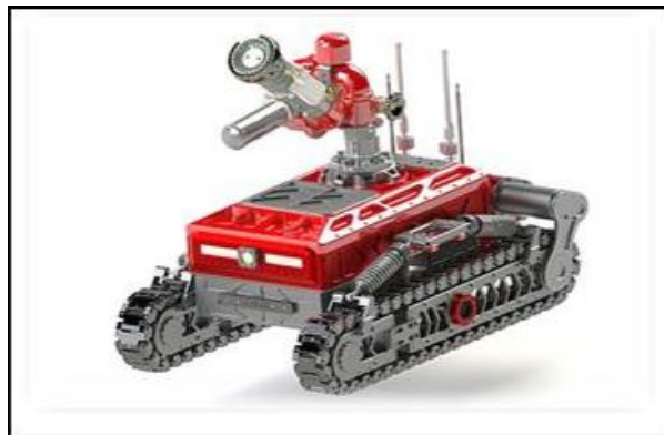
Figure 2: « Scarab Vulcain », conçu par la société TECDRON(France) et destinée à la lutte anti incendie.
