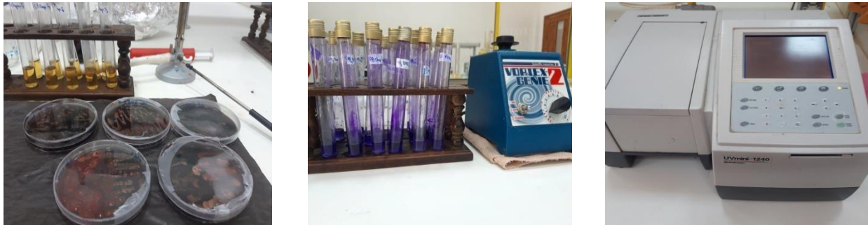
Figure 30. Préparation des cultures, coloration au Cristal violet pour et mesure de la DO
