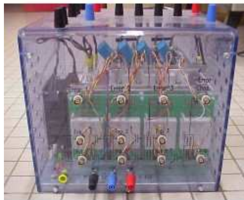
Figure IV.6 Onduleur de tension SEMIKRON
