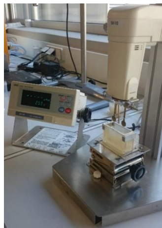
Figure IV.11. Viscosimètre à vibration type SV-10
