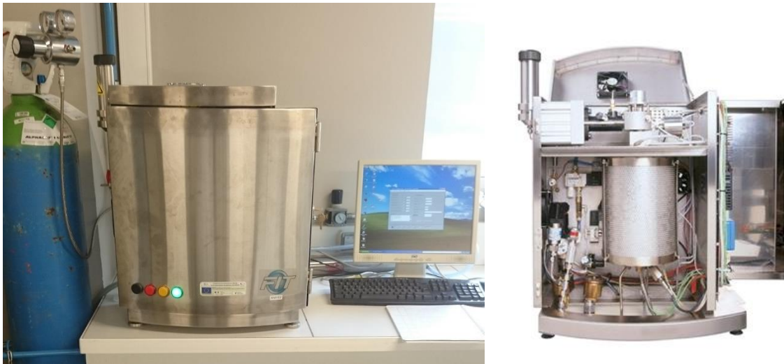
Figure IV.13. Testeur d'allumage de carburant (Fuel Ignition Tester - FIT)
