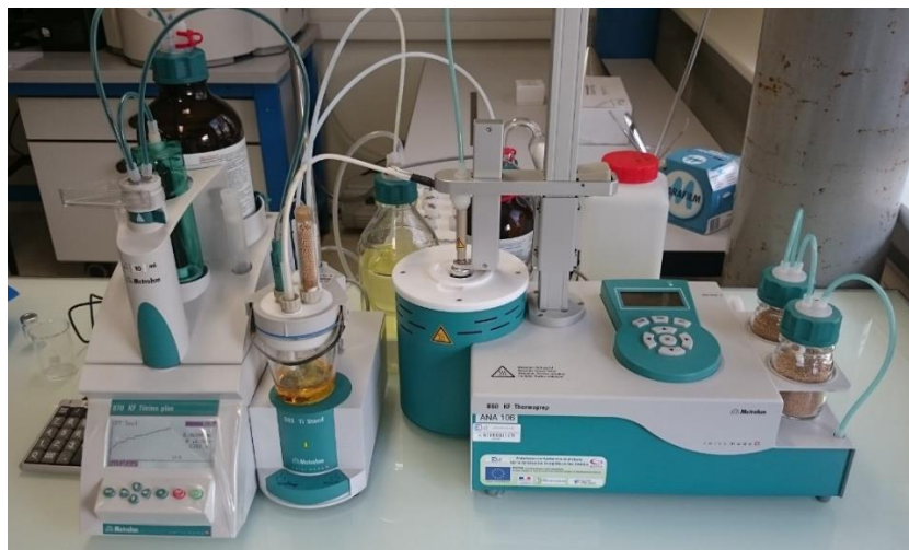
Figure IV.16. Appareil de mesure de la teneur en eau
