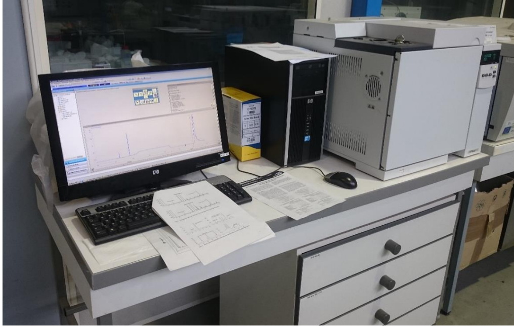
Figure IV.8. CPG-DIF Agilent 7820A
