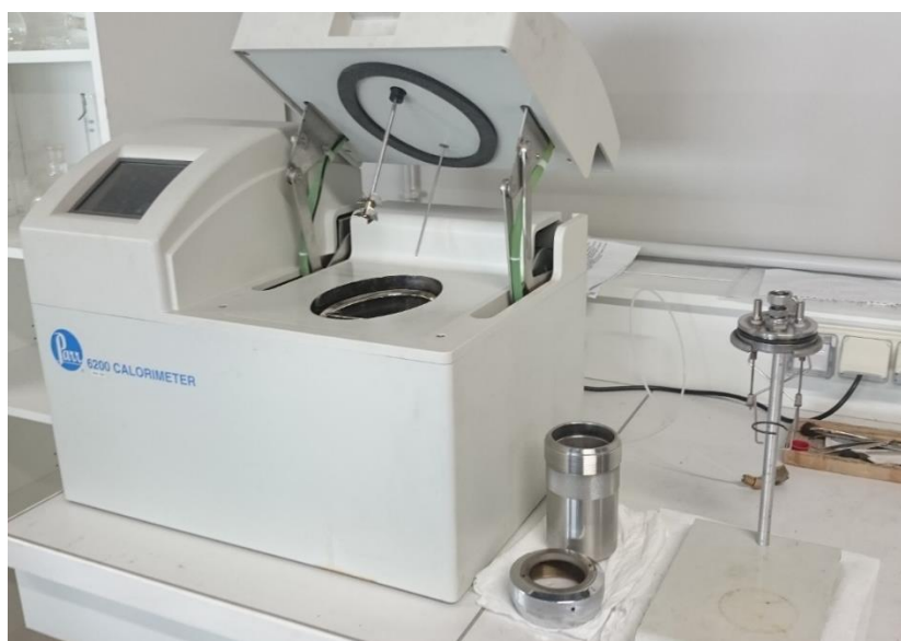
Figure IV.9. Bombe calorimétrique Parr 6200
