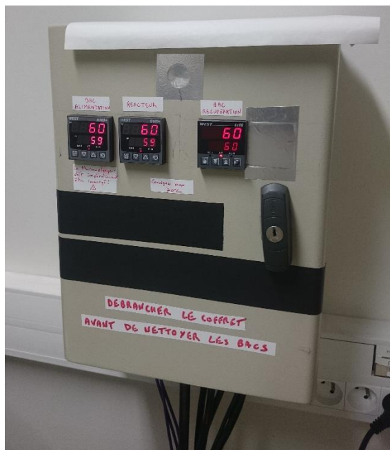
Figure IV.6. Unité de commande de la température
