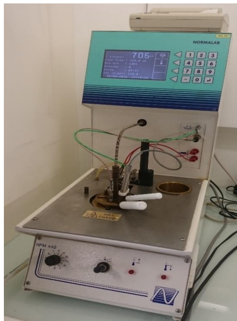
Figure IV.12. Appareil de mesure du point d'éclair
