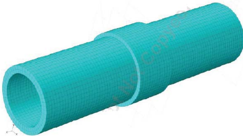
Figure II.20: Typique maillage FE pour le modèle globale [45].
