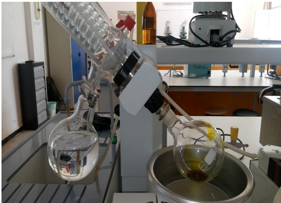
Figure 10 : L'extrait final pur obtenu par passage au rotavapor (laboratoire de biochimie générale)
