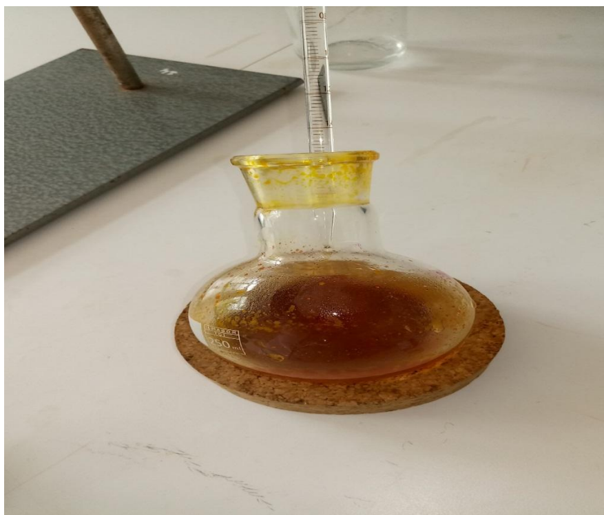
Figure 14 : L'ajout de l'indicateur coloré (phénophtaléine) à l'échantillon (laboratoire de biochimie générale)
