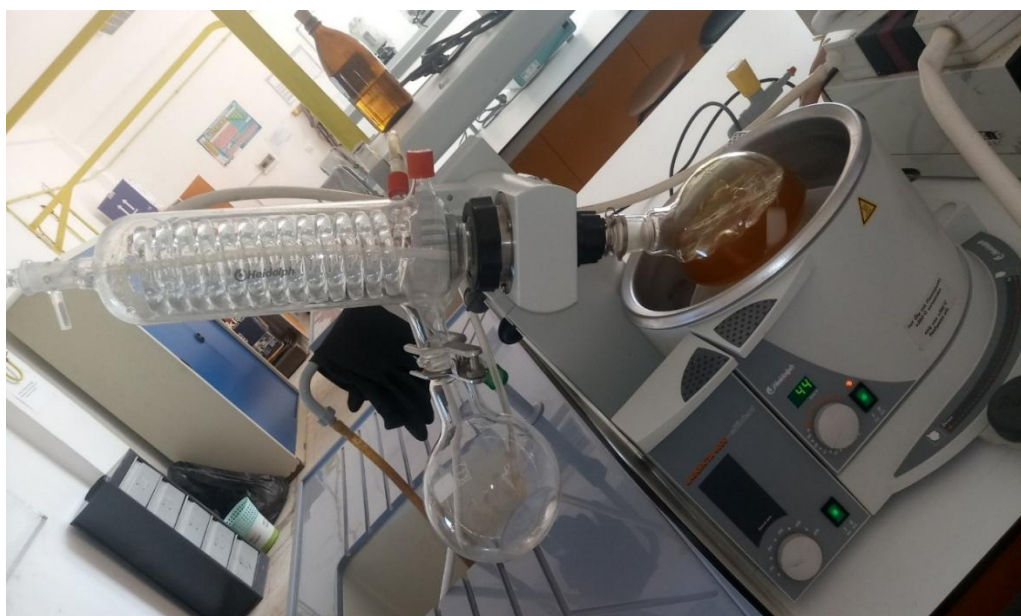
Figure 9 :Le montage d'un rotavapor (laboratoire de biochimie générale)
