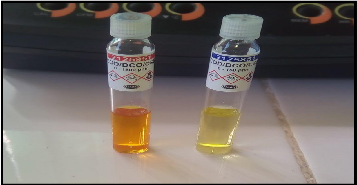
Figure n°58 : les deux tubes de réactif DCO pour l'eau épurée et l'eau Brute (SOUMIA, 2020)
