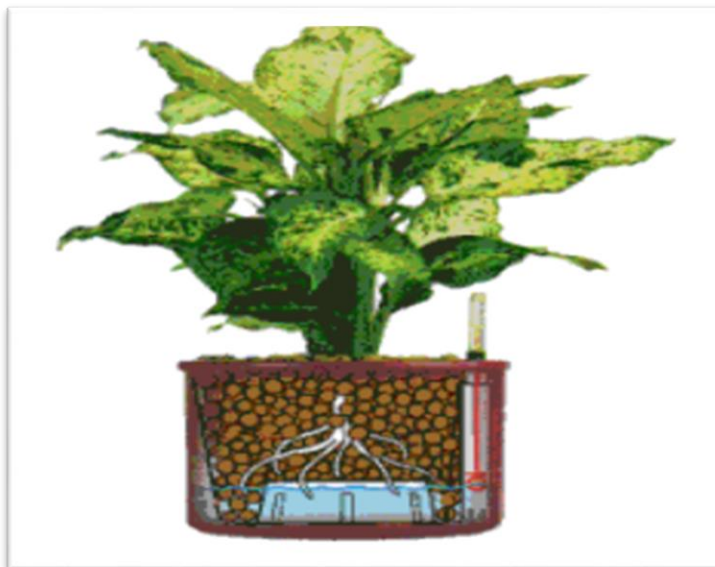
Figure 30: Schéma d'un système passif d'hydroculture [80].
