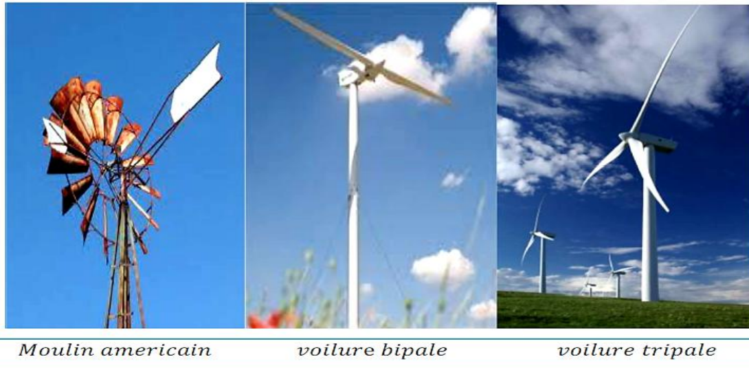
Figure.1.18-Eolienne à axe horizontal.
