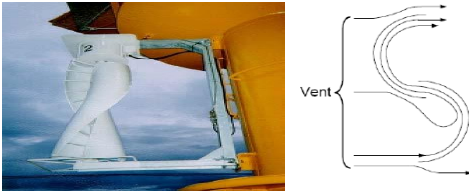
Figure.1.16-Eolienne à axe vertical (Structure de Savonius) [11]
