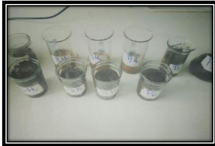
Figure n°67 : addition l'eau oxygénée sur les échantillons (Cliché BOUASRIA et AYAD 2020).
