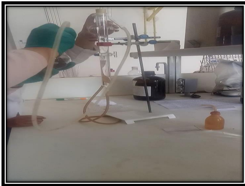
Figure n°54 : calcimètre de BERNARD (Cliché BOUASRIA ET AYAD 2020).
