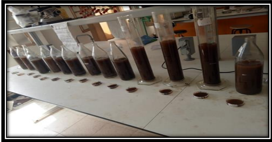
Figure n°71 : la sédimentation (prélèvement 3) (Cliché BOUASRIA et AYAD 2020).
