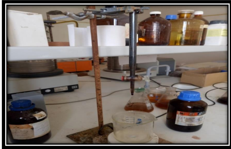
Figure n°59 : le titrage calcaire actif (cliché BOUASRIA et AYAD2020).
