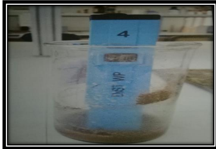
Figure n°66 : Mesure de la CE au conductimètre (Cliché BOUASRIA et AYAD 2020).
