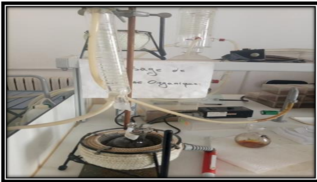
Figure n°62 : chauffage de la solution à la chauffe ballon (Cliché BOUASRIA et AYAD 2020).
