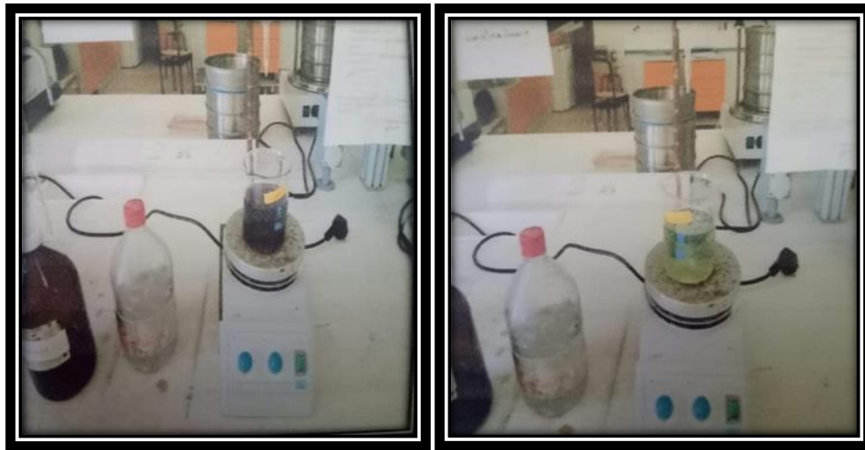
Figure n°64 : titrage de la solution de Mo (Cliché BOUASRIA AYAD2020).
