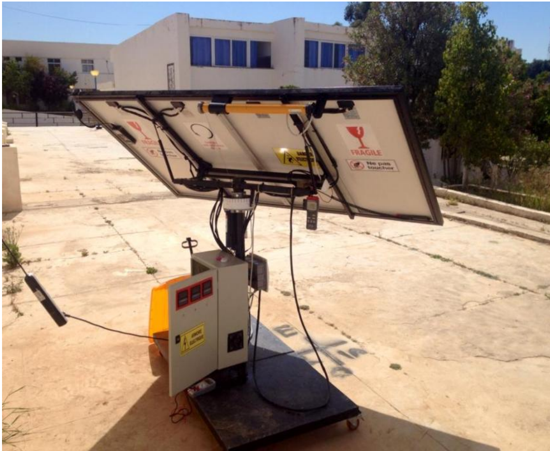
Figure 5.21 : Générateur photovoltaïque en période d'essais
