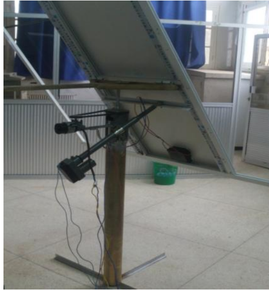
Figure 4.1 : Structure mécanique réalisée
