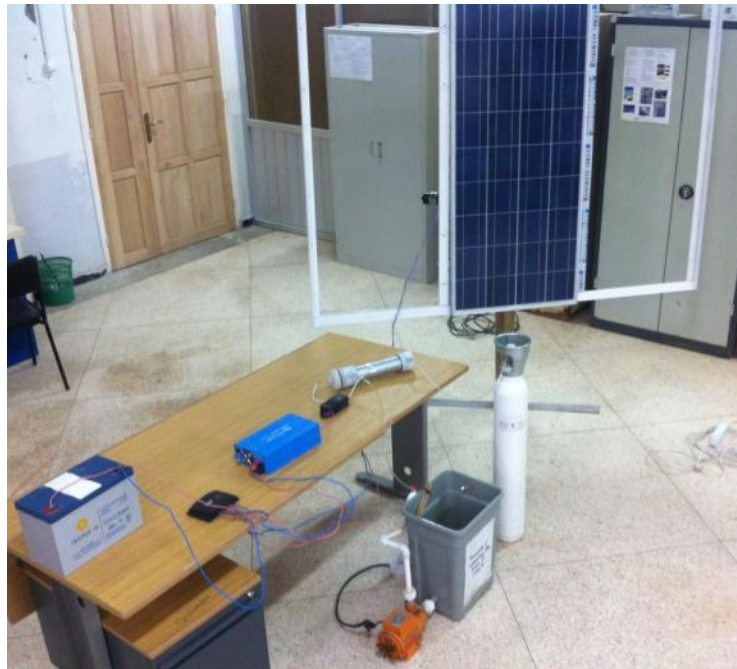
Figure 4.18.a: Schéma du générateur autonome photovoltaïque alimentant le générateur d'ozone.
