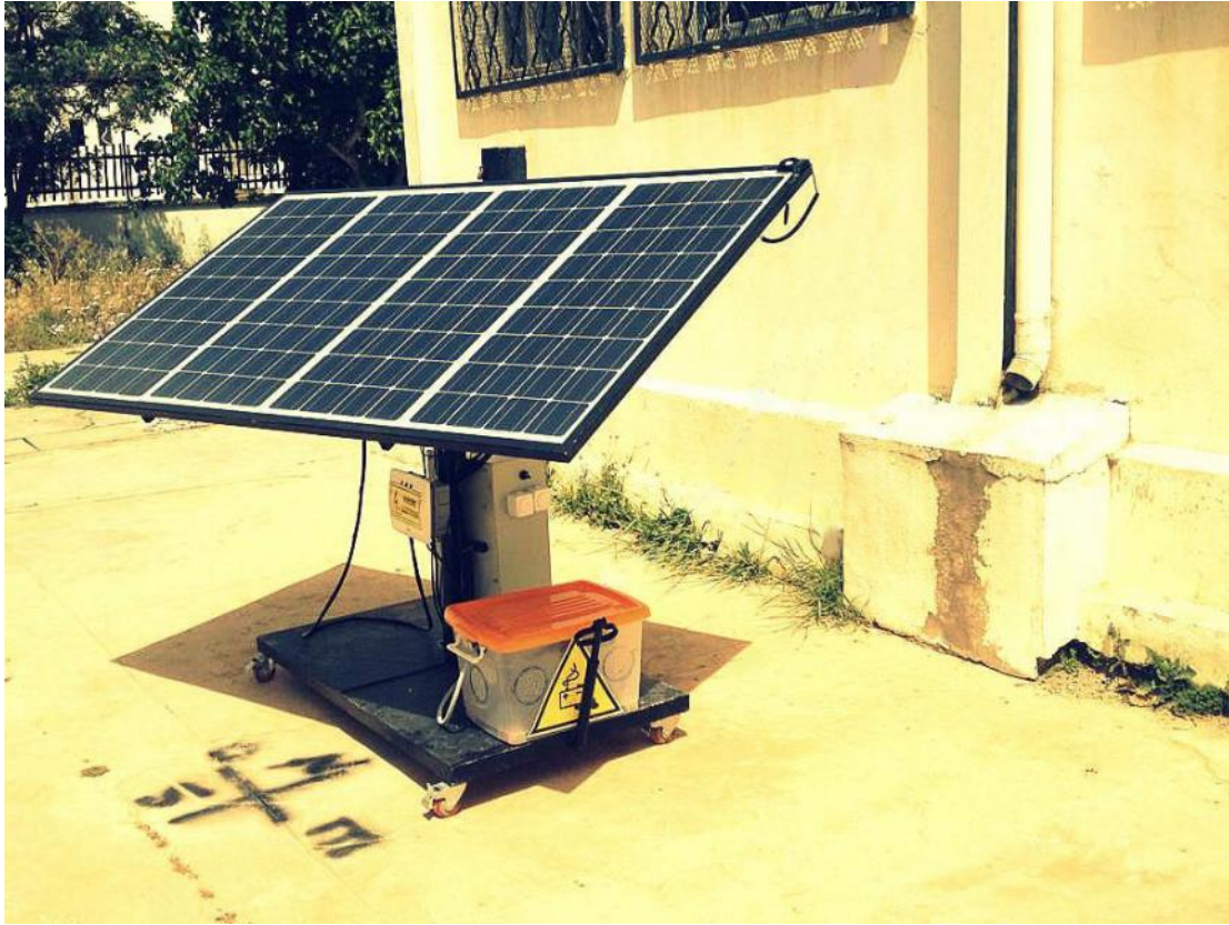
Figure 5.18 : Photo du générateur à deux axes de 340Watts
