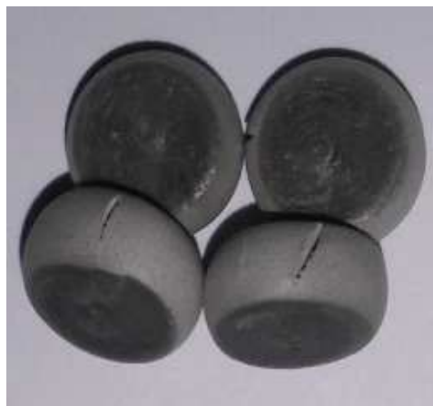
Figure III. 10 : Eprouvettes de compression endommagée.
