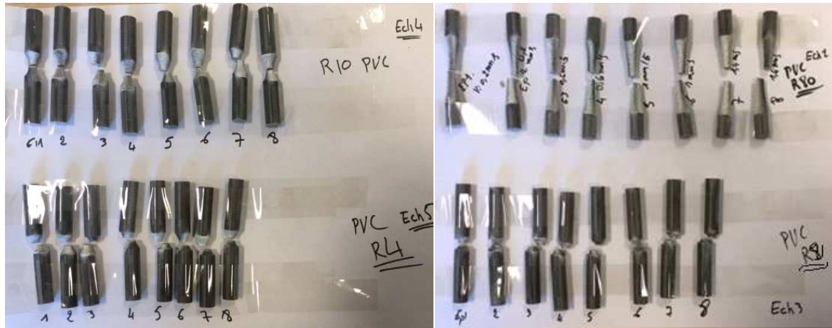
Figure III. 17 : Eprouvettes de traction ronde endommagé.
