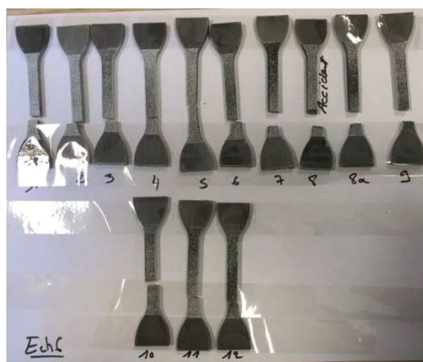
Figure III. 14 : Eprouvettes de traction plate endommagés.
