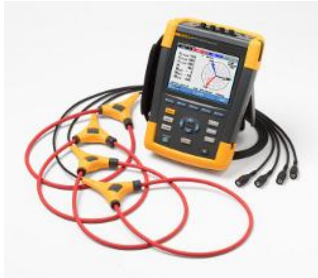
Figure III.22. Energimètre (FLUKE 435ii)
