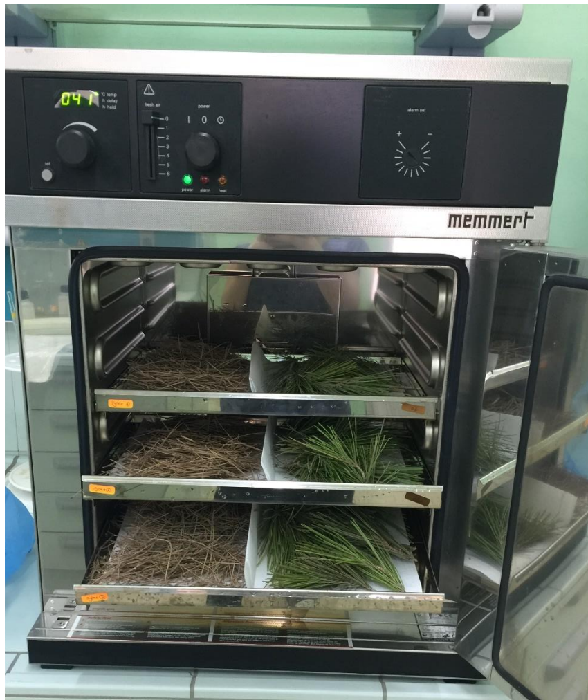
Figure 28 : Séchage des aiguilles à l'étuve à 40°C (pour le site urbain).
