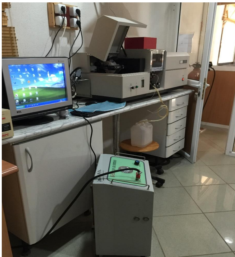
Figure 37 : Spectrophotomètre d'absorption atomique à flamme utilisé pour l'analyse.
