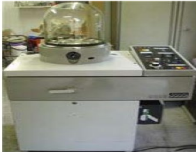
Figure II-16 : Système de revêtement sous vide poussé: évaporateur Edward 306[24].
