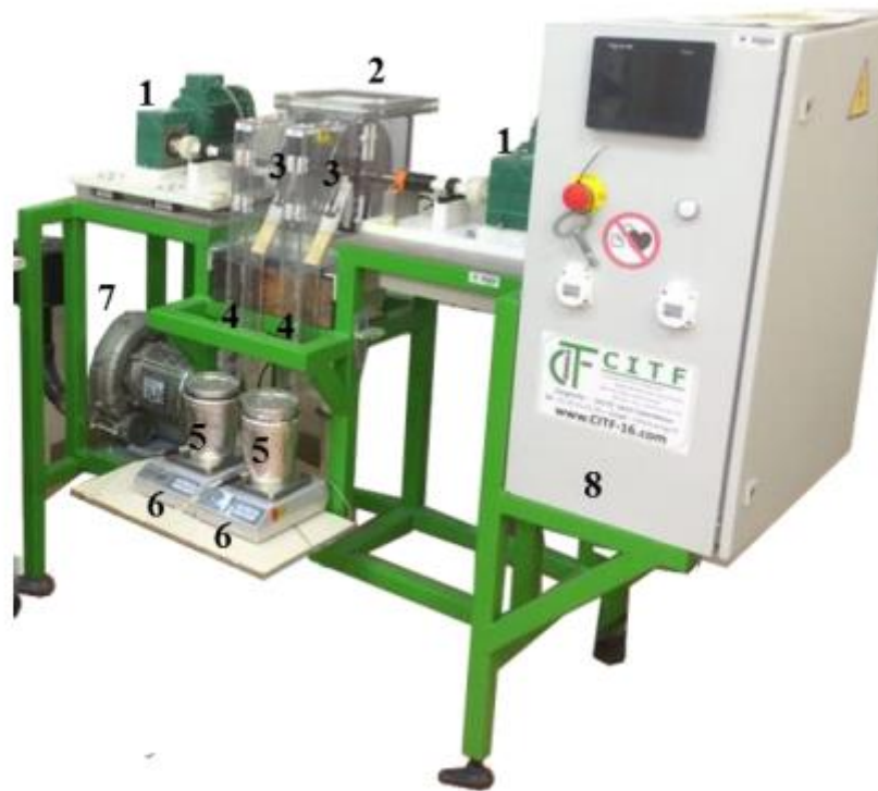
Figure I.15 Photographie d'un séparateur tribo-aéro-électrostatique à disques [55].
