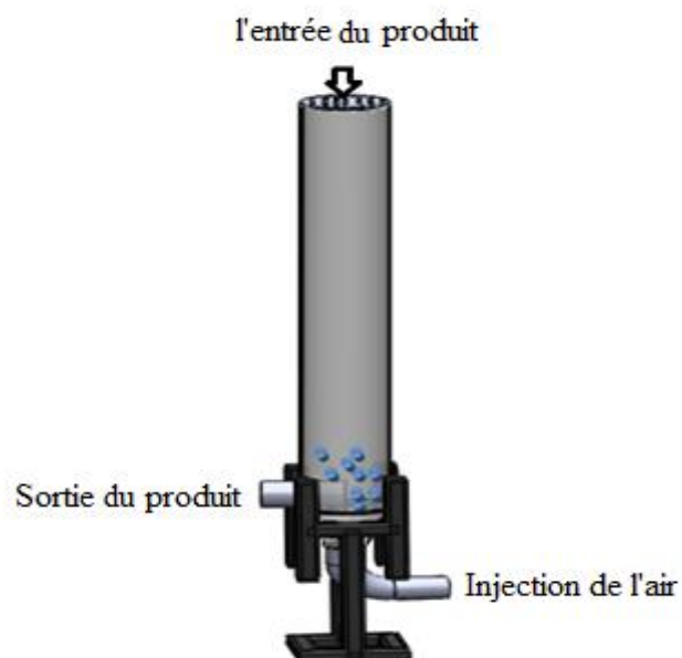
Figure II.4 Chargement tribo-électrique dans un dispositif à tube cylindrique
