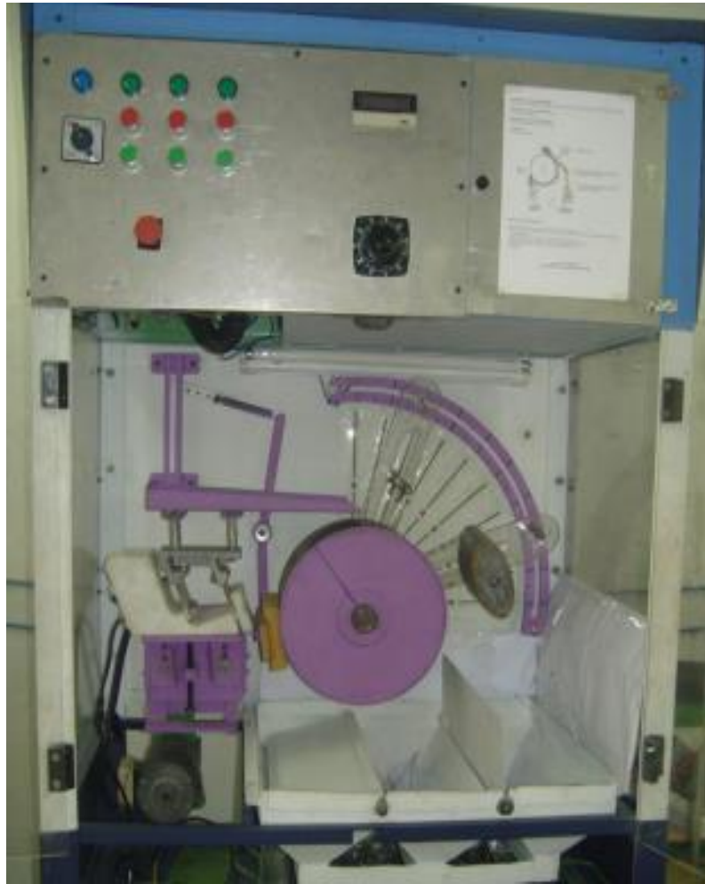
Figure I.21 Photographie de l'électro-séparateur réalisé au laboratoire IRECOM [77]
