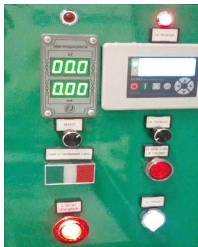
Figure III.4 Le panneau de réglage du séparateur
