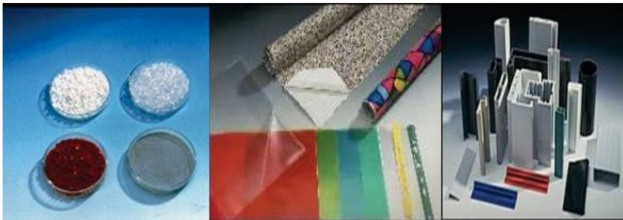
Figure I.1 Formes de livraison de la matière plastique première
