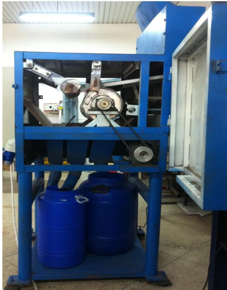
Figure I.22 Séparateur électrostatique à tambour industriel installé à l'ERO
