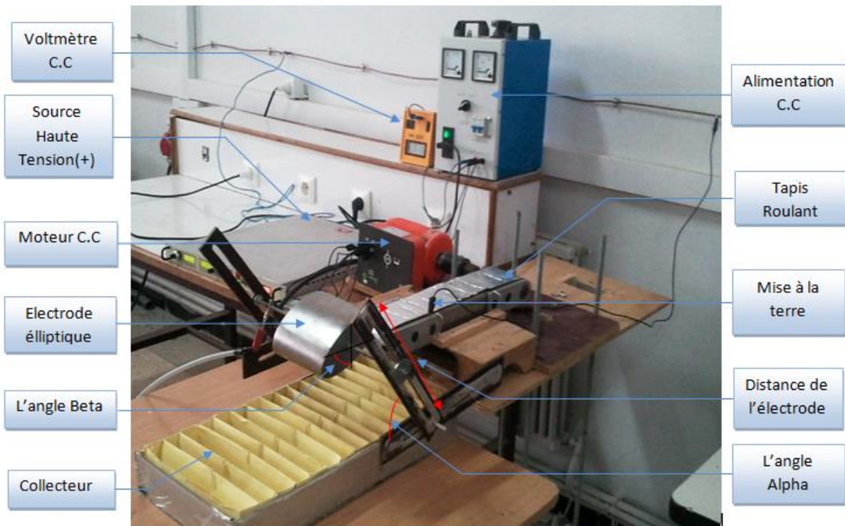
Figure V.10 Photos du séparateur à tapis roulant
