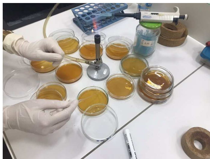
Figure 36 : Etalonnage à l'aide d'un étaleur stérile forme L.
