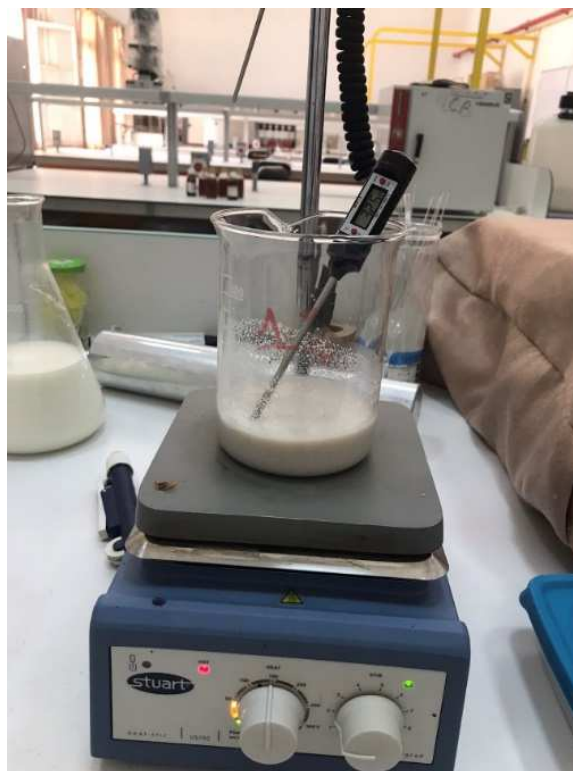
Figure 32 : Un test de la température de dissolution de la poudre dans le lait.
