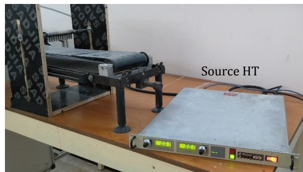
Figure II-13. Photographie du générateur de haute tension utilisé.
