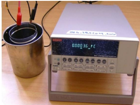
Figure II-10. Photographie de la cage Faraday et de l'électromètre 6514.
