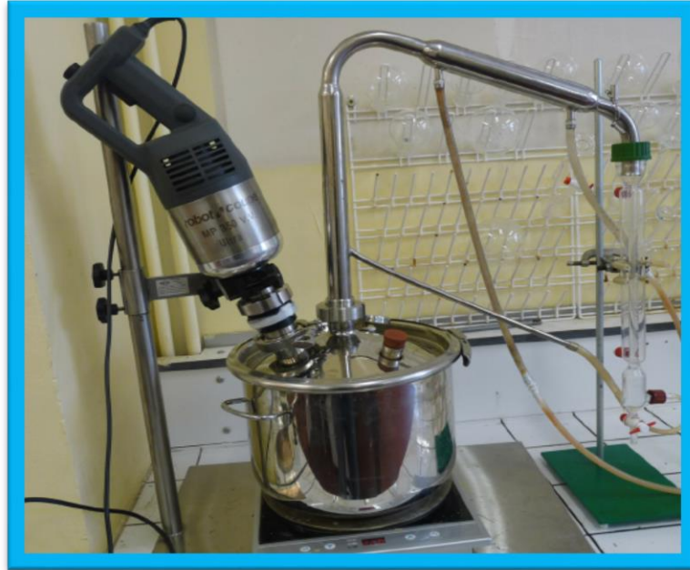
Figure 9 : Montage de l'extraction d'huile essentielle par hydrodistillation.
