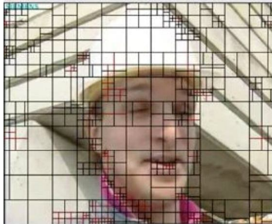
Figure III.5 Partitionnement d'une image en CUs par le codeur HEVC.
