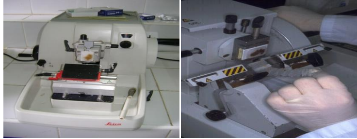
Figure 30: Coupe du bloc à l'aide d'un microtome (Leica) (Photos prises au service d'Anatomie pathologique, CHU de Sidi Bel Abbès)
