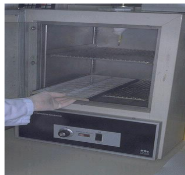
Figure 33: Séchage des lames dans le sèche-lames (Photo prise au service d'Anatomie pathologique, CHU de Sidi Bel Abbès)
