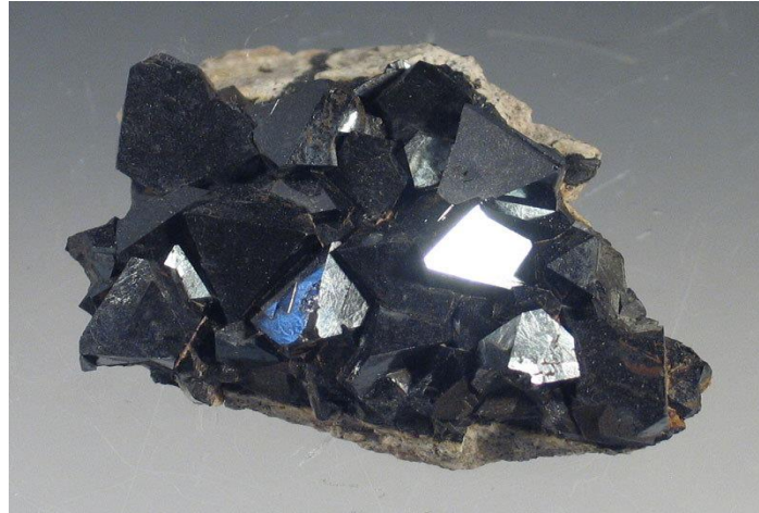
Figure. I.4 : la magnétite, minéral présentant des propriétés magnétiques, intriquait déjà les grecs il y a 2600ans
