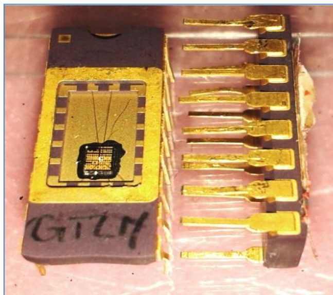
Figure III.2: Photographie du HEMT encapsulé dans un boîtier de circuit intégré.
