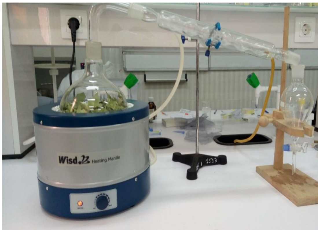
Fig 24 : Dispositif d'extraction par hydro-distillation (Clevenger). (ABAHRI Hakima ; 2017)
