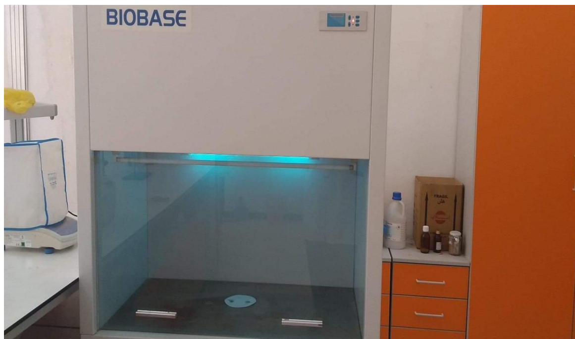
Figure 09 : Observation des disques sous la lampe ultraviolette intégrée d'une hotte de marque BIOBASE ®
