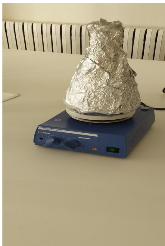
Figure 06 : Préparation de l'extrait de cannelle par macération sous agitation ®
