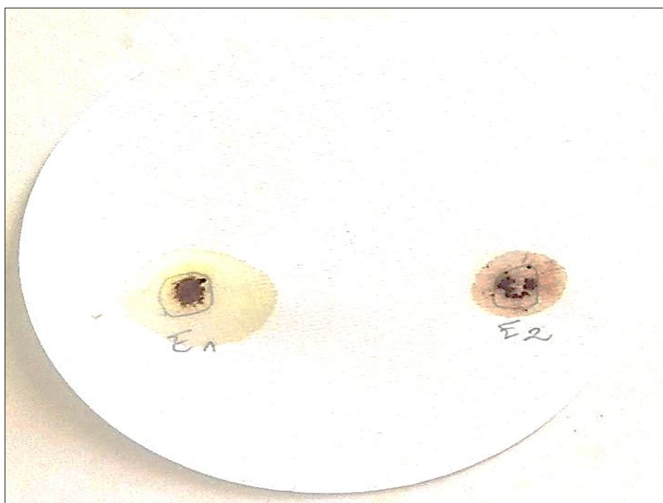
Figure 10 : Résultat du screening de la coumarine dans les deux extraits de cannelle : E1 extrait d'éthanol pur ; E2 extrait traité par la chaleur.
