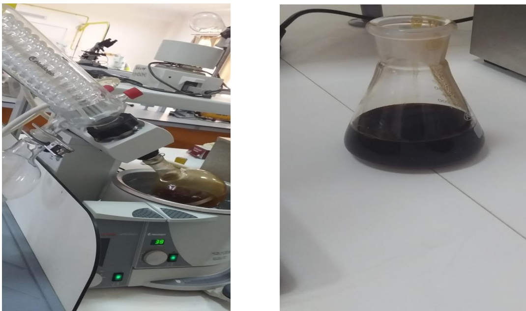
Figure 08 : Elimination du solvant par évaporation rotative ®
