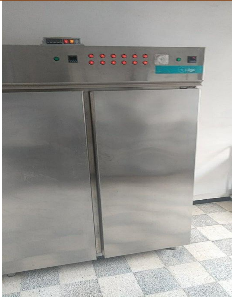
Figure 30 : Le germoir du laboratoire de CNCC (cliché REBAH et SAIDI , 2021)
