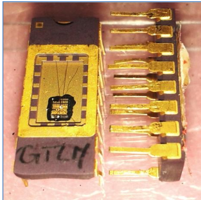
Figure III-2: Photographie du HEMT encapsulé dans un boîtier de circuit intégré.
