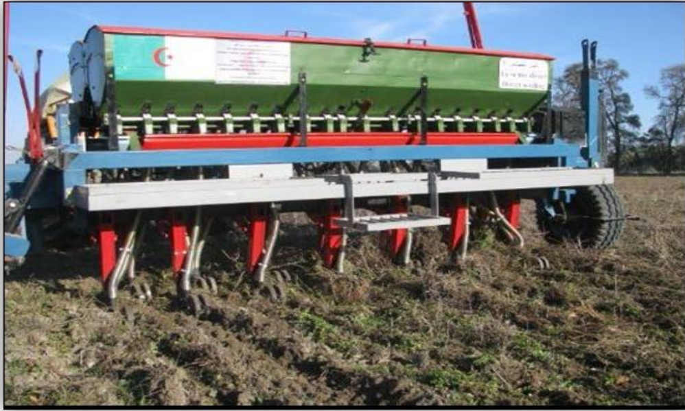
Figure 07 : Semoir John Shearer de type australien : semis direct
