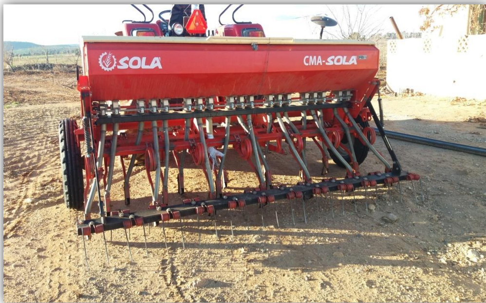
Figure 08 : Semoir en ligne avec tube de descente en ligne : semis conventionnel
