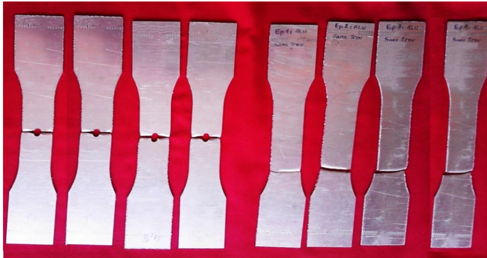
Figure II.11 résultats des essais expérimentaux sur les éprouvettes trouées et non trouées.
