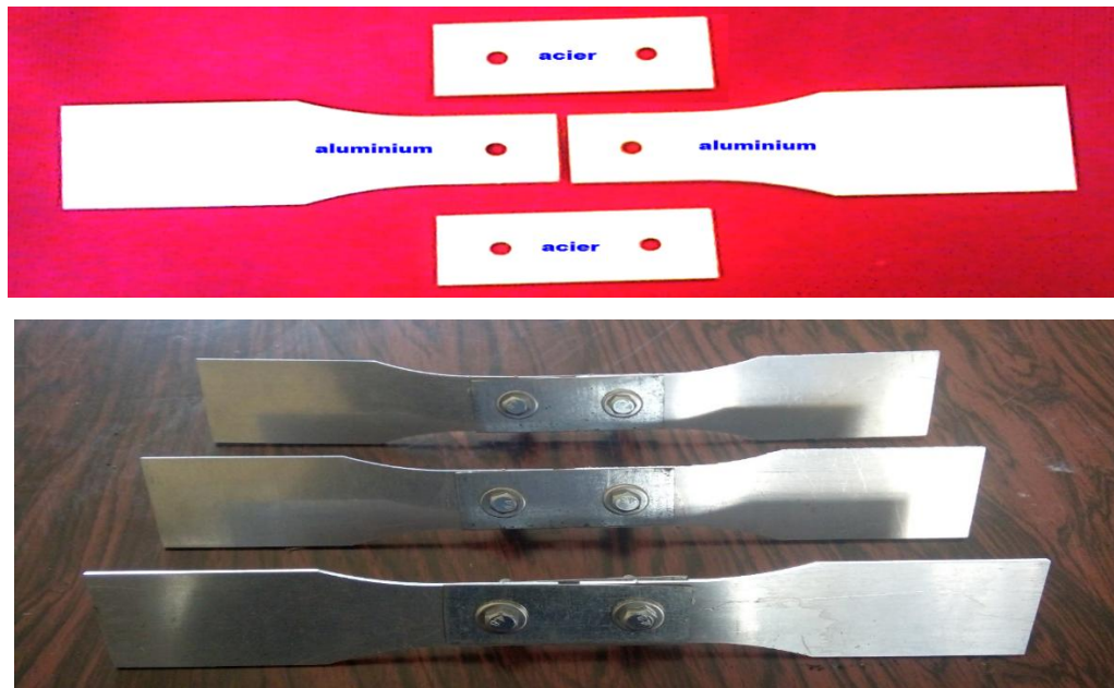
Figure II.7 préparation des éprouvettes boulonnées.
