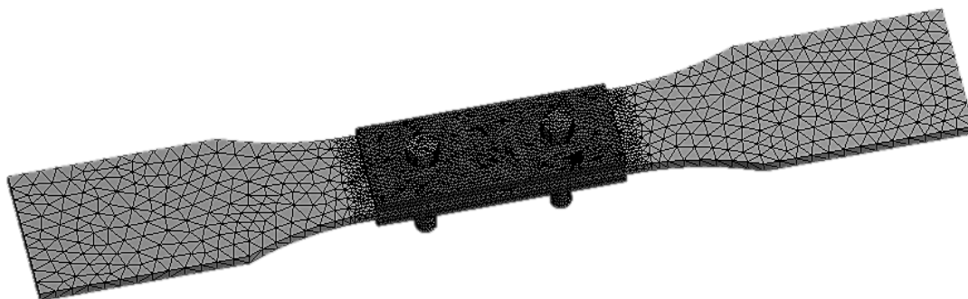
Figure III.17 le maillage d'éprouvette par ANSYS.
