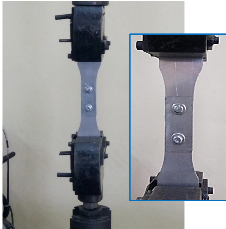
Figure II.9 : Montage utilisé pour simuler l'essai de fretting fatigue.
