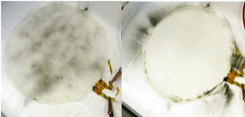
Figure 2.11. Photographies de l'EDS transparent de 20 cm de diamètre pour la fenêtre PEM pendant les tests en laboratoire. La poussière de stimulant JSC-1A a été déposée de manière relativement uniforme, comme indiqué sur la gauche. La photo de droite montre l'EDS après activation
