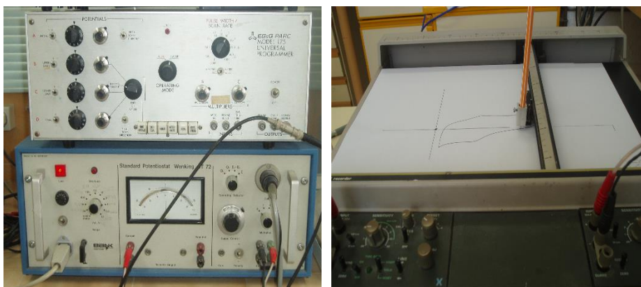
Figure 4 : a) potentiostat Standard Potentiostat Wenking ST 72, relié à un générateur de signal (EG&G PARC mod. 175 etb ) un enregistreur XY Philips model PM 8133
