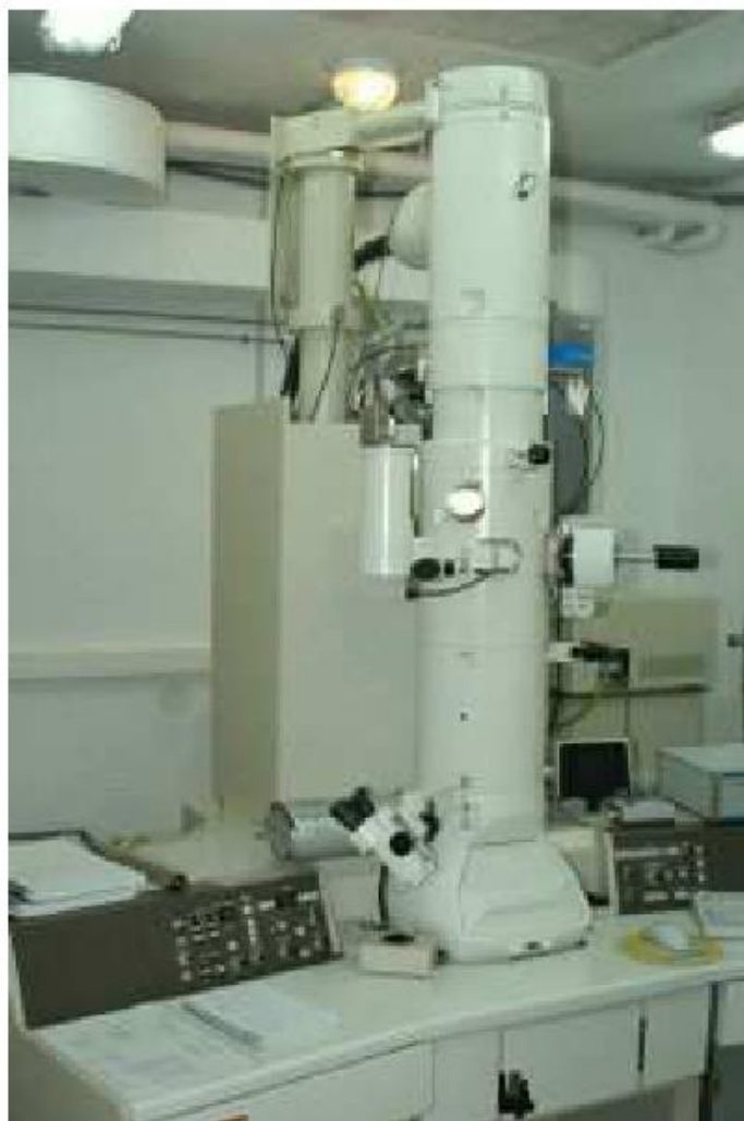
Figure 7. Microscope de MET de type JEM-2010 JEOL
