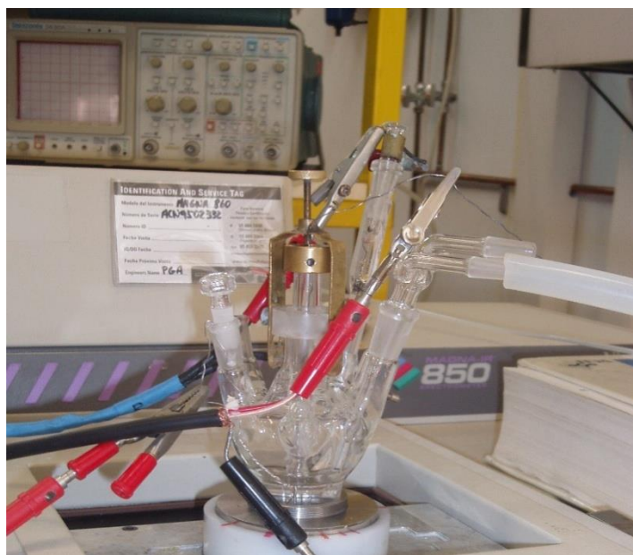
Figure 12 : Cellule spectro-électrochimique avec une fenêtre prismatique en \text{CaF}_2 installée pour un montage de FTIR in situ
