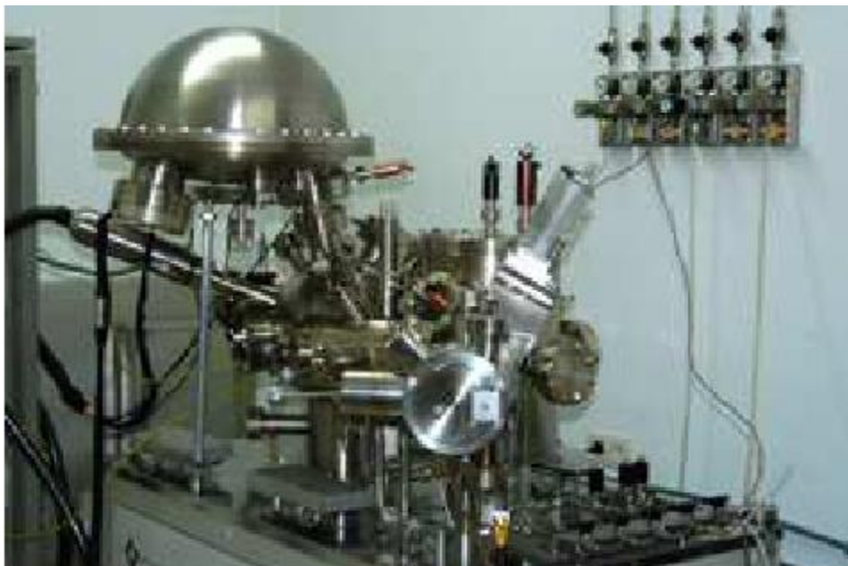
Figure 4 : un spectromètre d'électrons XPS de type VG-Microtech Multilab 3000
