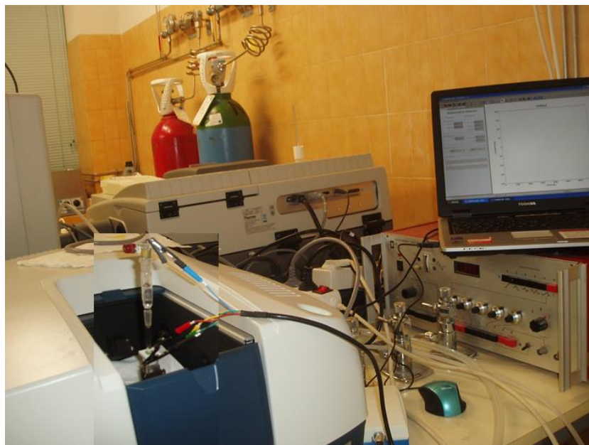
Figure 19 : un spectrophotomètre UV Jacco V-670 lié à un potentiostat de type DropSens \mu Stat400 et un ordinateur portable.
