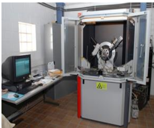
Figure 6. Appareil de Diffraction des Rayons X. modèle Bruker D8-Advance
