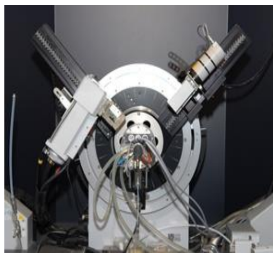
Figure 6. Appareil de Diffraction des Rayons X. modèle Bruker D8-Advance
