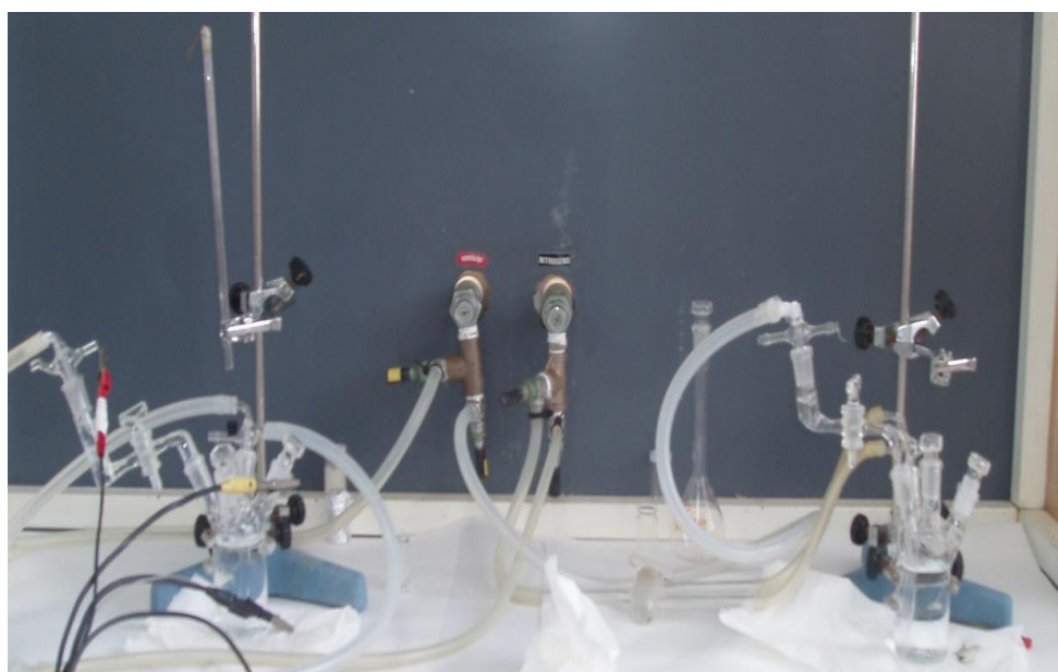
Figure 2 : Montage de deux cellules de travail qui contiennent une solution de \text{H}_2\text{SO}_4 0.5\text{M} et dans la deuxième on ajoute 10^{-3}\text{M} de crésol.
