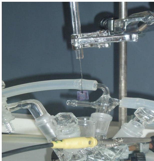
Figure 9 : cellule électrochimique contenant une électrode d'oxyde métallique dans une solution de crésol dans H_2SO_4 0.5M
