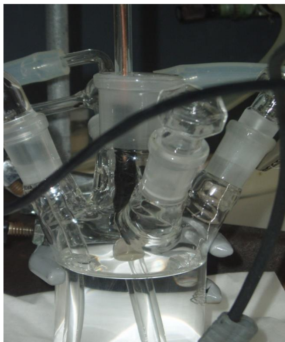
Figure 10 : cellule électrochimique contenant une électrode de platine immergée à 50% dans une solution de de crésol dans H_2SO_4 0.5M
