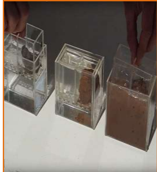
Figure n° 15 : Matériel du slake test vendu dans le commerce
