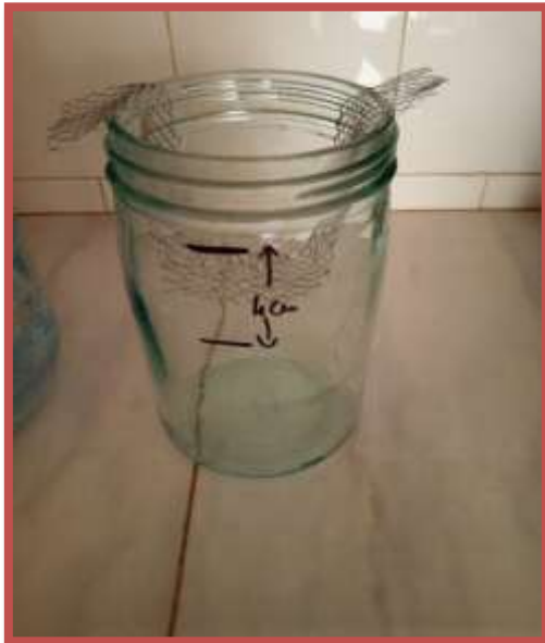
Figure n°14 : Matériel utilisé pour le slake test (cliché Hadjazi Z., 2020)
