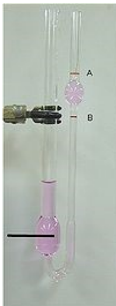
FIGURE 2.8 – Schéma d'un capillaire pour viscosimètre type KPG Cannon - Fenske.
