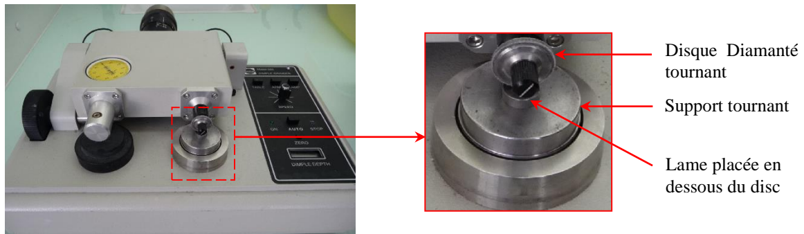
Figure II.24 : Erosion du centre de la lame mince au moyen d'un Dimple-Grinder.
